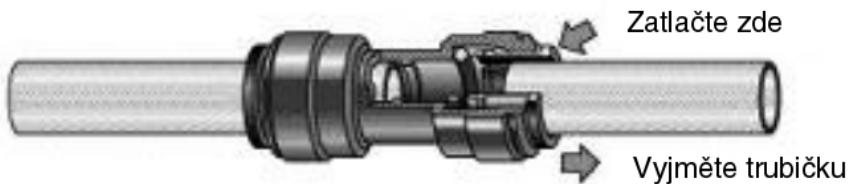
Zatlačte hadičku pevně do šroubení dokud to půjde. Pro jistotu zkuste trubičku vytáhnout. Pokud trubička vypadne, zatlačte znovu. Pokud drží, je to správně.
